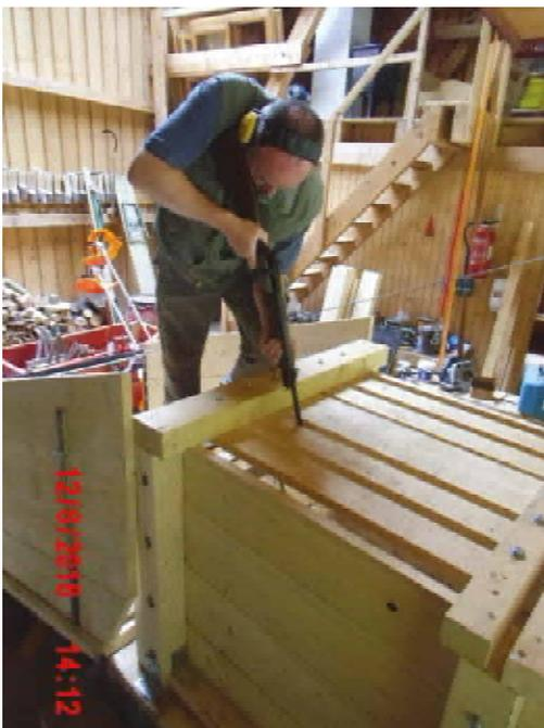
Bild 6 die obere Abdeckung der Kiste hat Lücken, über die ein Gewehr eingeführt werden kann.
