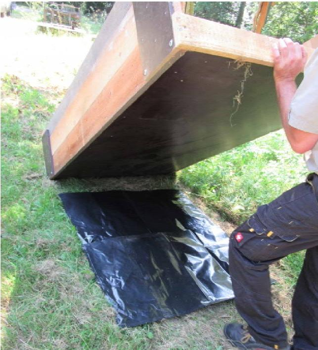
Bild 10: auf der Folie werden die Durchschusspositionen bestimmt
