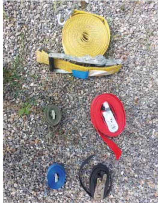
Abbildung 122: Unterschiedliche Spanngurte, welche in Abhängigkeit der Baumentfernung eingesetzt werden können.
