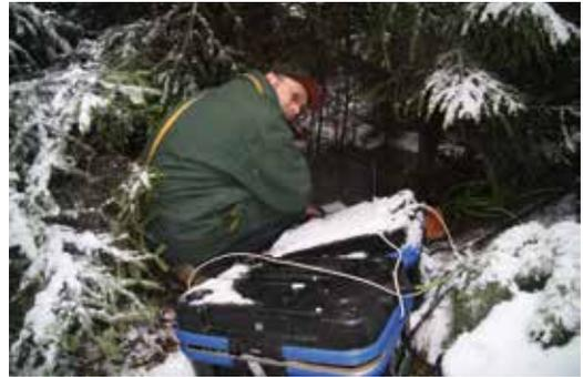
Abbildung 19: Die Energieversorgung ist nur mit Hilfe großer Blockbatterien möglich, welche alle zwei Tage gewechselt werden mussten.
