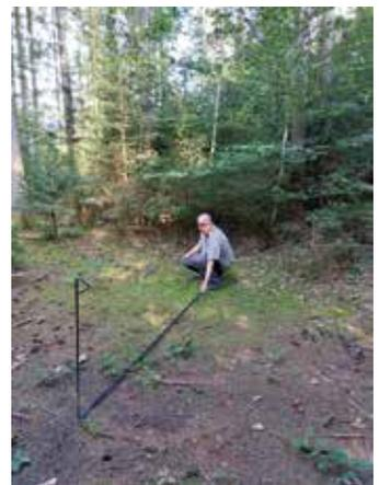
*Nach der Empfangsüberprüfung wird der Standort auf Platzeignung untersucht (Weiße Markierung auf schwarzem Abstandsband ist Bodennetzinnenkante + ca. 70 cm ist gesamter Bodennetradius), ob ein entsprechender Platz sowie eine notwendige Bewuchs- und Wurzelfreiheit vorhanden ist*
