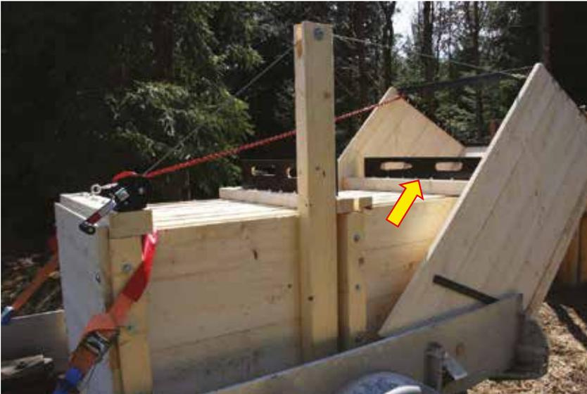
Bild 5 in diesem Rüstzustand (Rampe hochgezogen über Seilwinde mit Drahtseil gesichert) ist die Kiste transportfähig, der Schieber schließt die Kiste.
