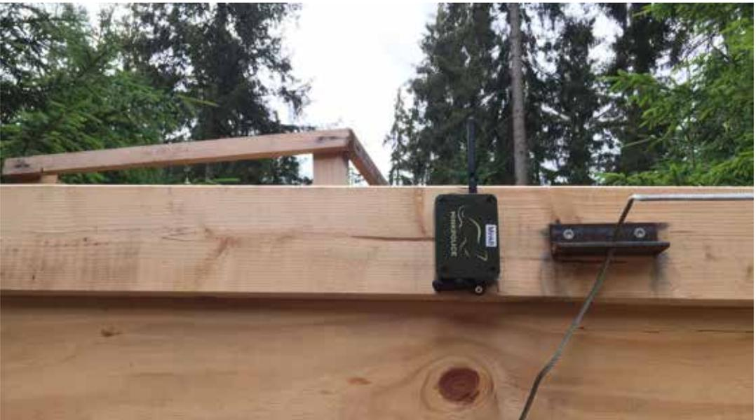
Abbildung 24: Zur Überwachung von Fallenauslösungen können Fallenmelder verwendet werden. Gekoppelt an den Auslösemechanismus des Tores schickt der Fallenmelder bei Auslösung ein entsprechendes Signal.
