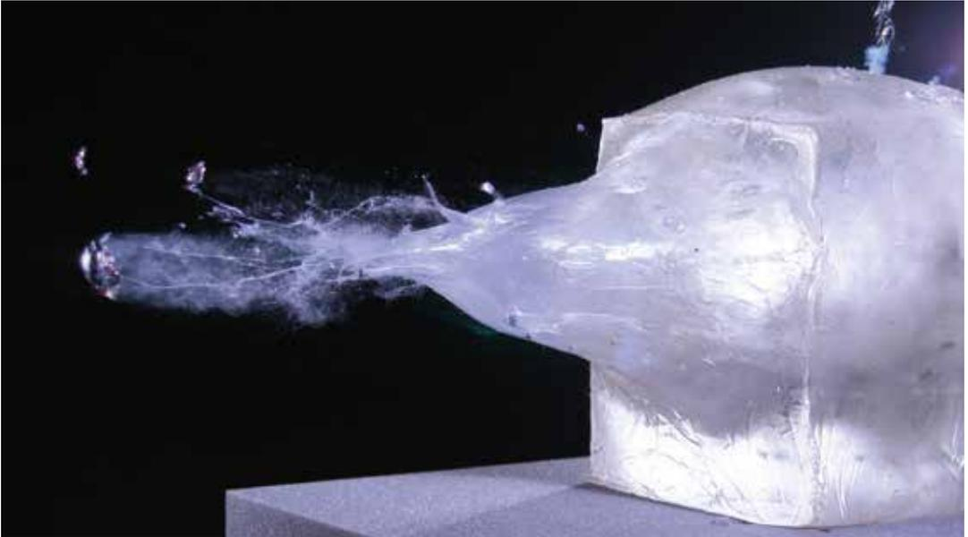
Abbildung 77: Schuß auf einen Gelatineblock, Kaliber .243, Federal Power-Shok 100 grn. Markiert ist das Projektil und die Grenze der Druckwelle innerhalb des Gelatineblocks (Bildquelle: Nathan Boor & Kurt Groover of Aimed Research, Wikimedia Commons, unverändert. <https://commons.wikimedia.org/w/index.php?curid=34771284>).
