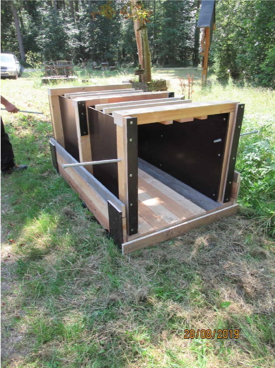
Bild 11: Gesamtansicht der stationären Abfangkiste mit U-Profil
