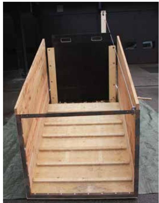
Abbildung 29 a, b, c: Anhängerbasierte Abfangkiste, welche fest auf einem PKW-Anhänger (Traglast > 1.300 kg) fixiert ist und über eine schwenkbare Rampe verfügt.
