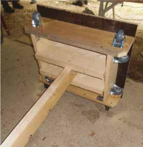
Bild 11 Schieber zum Bewegen der Sau – an allen Seiten sind Rollen montiert um das Bewegen zu erleichtern
