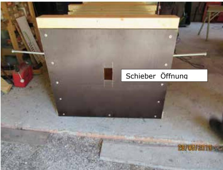
Bild 2: Kopfseite Öffnung zum einführen des Schiebers, es kann der Schieber aus der mobilen Abfangbox verwendet werden
