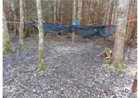
Abbildung 13 a, b: Das Netzfangsystem kann in jeglichen Waldbeständen an Bäumen befestigt werden.
