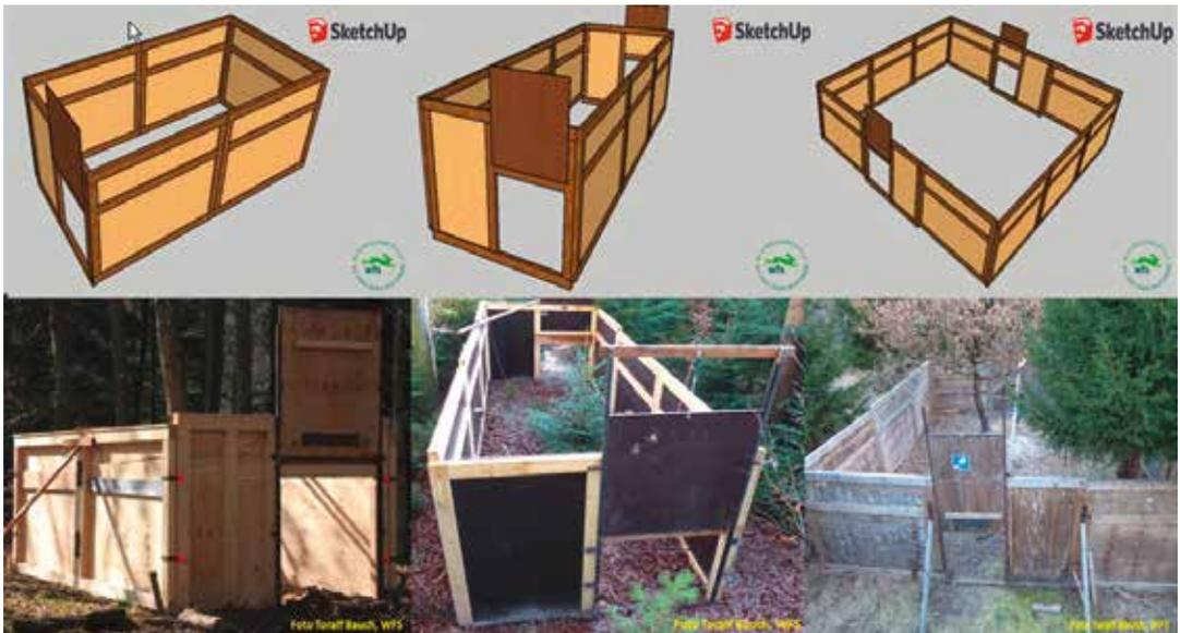
Abbildung 3: Die in Modulbauweise zusammengestellten Fangsysteme können sowohl als Groß- oder Kleinfänge genutzt werden.
