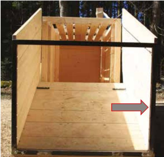
Bild 1 Rampe nach unten geklappt, verfügt über einen Metallrahmen zur Seitenstabilität und zur Führung des Schieber
