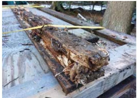
Abbildung 117: Beim Wechsel einzelner Balken und der Verwendung von Siebdruckplatten kann von einer höheren Lebensdauer ausgegangen werden.
