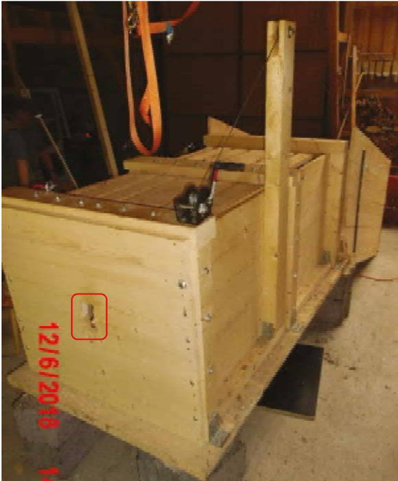
Bild 13 Kiste verladefähig in dieser Öffnung wird die Schiebestange geführt
