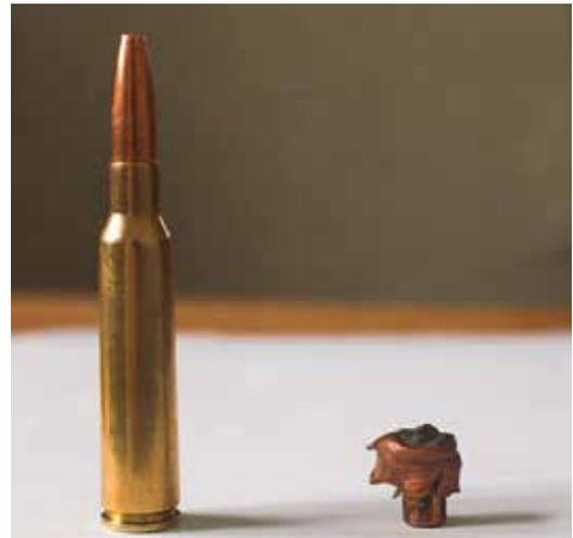
Abbildung 53: Teilmantelprojektil vor und nach dem Auftreffen in einen Zielkörper.
