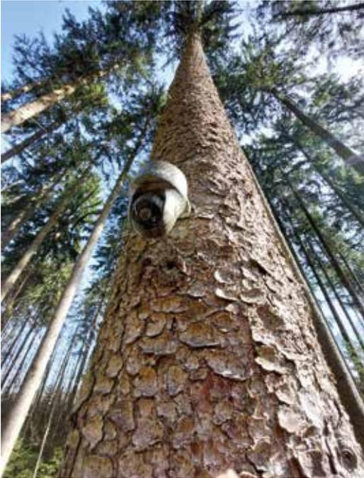
Abbildung 20: Videokameras (Bsp.: Reolink Keen Ranger PT) ermöglichen neben einer variablen Fernausrichtung eine Videoaufzeichnung, einen „Rund um die Uhr“-Livestream und verfügen genauso über eine Sprechfunktion, um eine Standortkommunikation mit anderen Personen zu ermöglichen. Die Übertragung erfolgt per Mobilfunk (4G/LTE).
