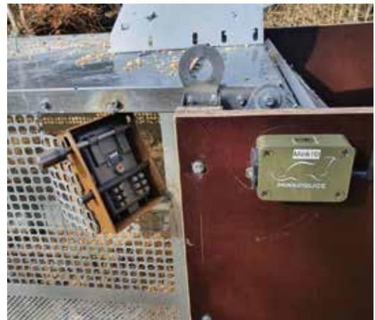
Abbildung 79: Bei der Lotin®-Falle wurde jeweils entgegengesetzt an jedem Ende der Falle eine Fotofalle (Bushnell) angebracht, um so den Innenbereich überwachen zu können. Aufgrund der geringen Größe der Falle sind die Bildausschnitte sehr klein. (Bild: Potell, HSR).
