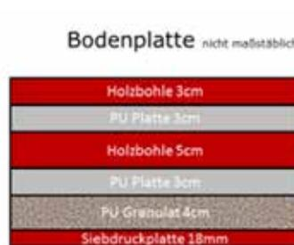
Bild 8: Ergänzender Beschuss der mobilen Abfangkiste als Nachtrag I zum Gutachten Nr.18/06.12. Kontrolle der Bodenplatte der mobilen Abfangkiste, bei der es weder zur Durchschlagung dieser durch Projektile oder Splitter kam.
