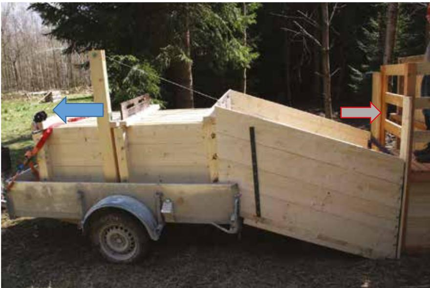
Bild 2 Transportmöglichkeit ist ein Anhänger, die Rampe kann über eine Seilwinde nach oben gezogen werden.
